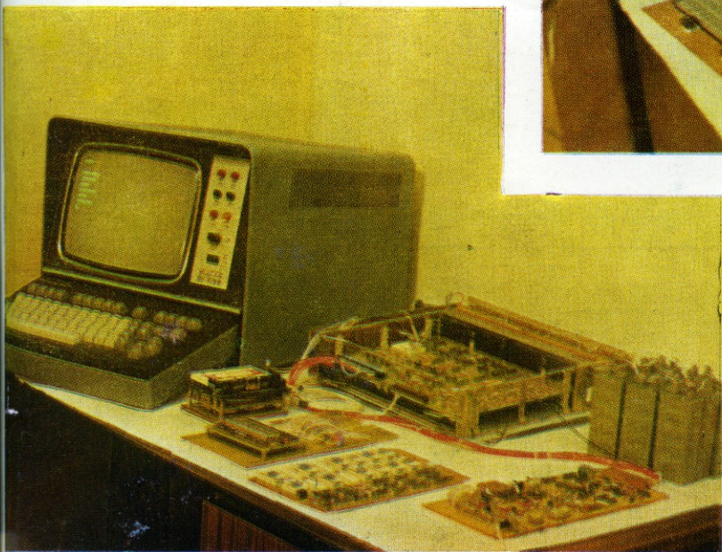
Внутренняя компоновка электронной аппаратуры станции; в центре сферы виден блок измерительно-вычислительного комплекса, выполненного на основе серийной микроЭВМ «Электроника-ИЦ-80/01Д».
